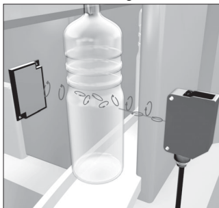
Verwendung des Doppelbrechungseffekts bei PET für höhere Erfassungsstabilität (für PET optimierte Modelle)
