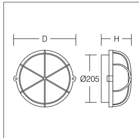
Plafonnier et applique robuste pour l'extérieur. Luminaire et grille de protection en aluminium injecté traité époxy. Avec valve à membrane pour réduire la condensation. Diffuseur en matière synthétique (polycarbonate) opalin. Étrier de fixation en inox avec compensation de la tolérance des trous de perçage. Raccordement secteur 2 x 3 x 1,5 mm<sup>2</sup>. Module LED échangeable.
