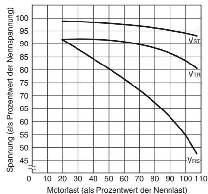
**Hinweis:** Bei Phasenausfall von Phase R.  $V_{ST}$ ,  $V_{TR}$  und  $V_{RS}$  geben die Spannung der Motorklemmen bei Phasenausfall an.
