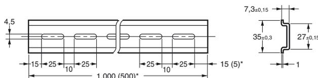
\*Abmessungen in Klammern sind Abmessungen für PFP-50N.
