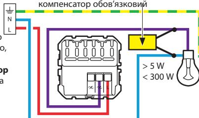
Розумний вимикач (з функцією світлорег.) працює з стандартними або лампами, що регулюються, включаючи світлодіоди потужністю понад 5 Вт. Викор. регулюєм. світлод. ламп обов'язкове для кращого результату. Якщо компенсатор підключеній,
