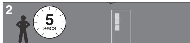
Wacht nog eens 5 seconden voor de sensor te stabiliseren, maak dan een beweging, het licht moet dan weer aanschakelen. Kijk of dat de detectie / non-detectie is zoals verwacht.
