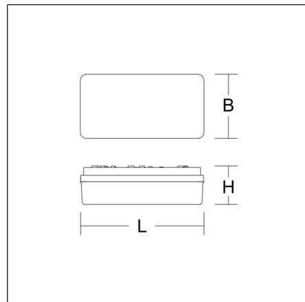
Leuchte zur Rettungswegkennzeichnung. Armatur Kunststoff Diffusor Kunststoff opal 4 Folien zur Rettungswegkennzeichnung beigelegt (nach ISO 7010). Geeignet für Wandanbau. Betriebsgeräte integriert. Einzelbatteriesystem mit automatischem Selbsttest und Rückmeldung an das RZB Überwachungssystem MULTIDIGIT.
