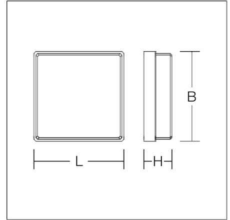
Quadratische Hausnummernleuchte. Armatur Kunststoff. Diffusor Kunststoff opal seidenmatt. Befestigung des Diffusors mit Federsystem. Mit Dämmerungsschalter, über DIP-Schalter in mehreren Stufen einstellbar (2-500 lx). Beschriftung bitte separat bestellen!
