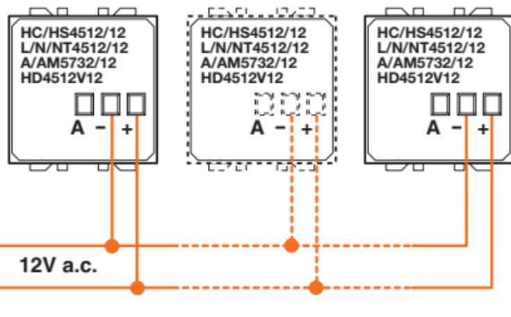
Voor installaties met 3 toestellen, de transformator art. F91/12E gebruiken
