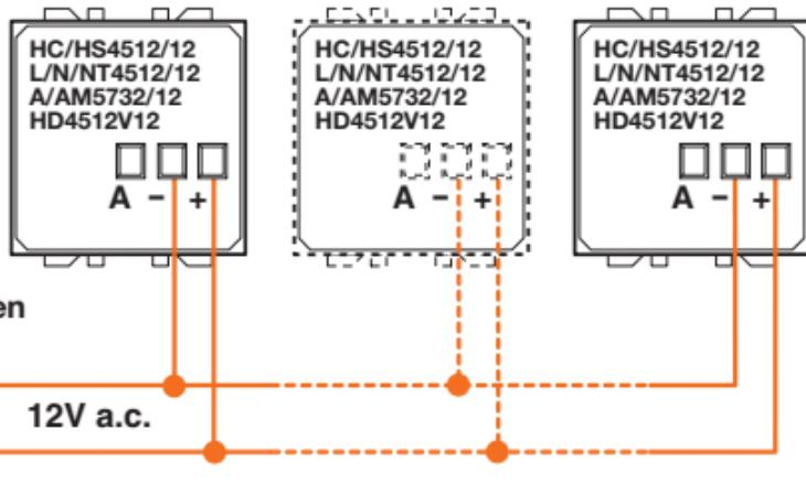
Für Anlagen mit 3 Geräten, den Transistor Art. F91/12E verwenden
