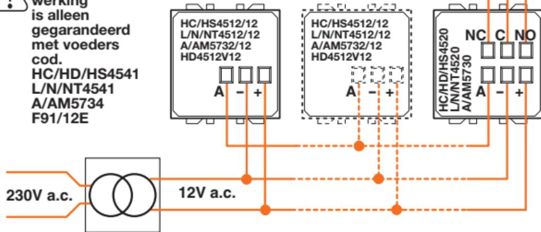
Voor installaties met 3 toestellen, de transformator
