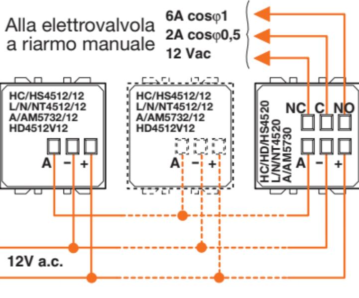
Per impianti con 3 apparecchi utilizzare il trasformatore art. F91/12E.
