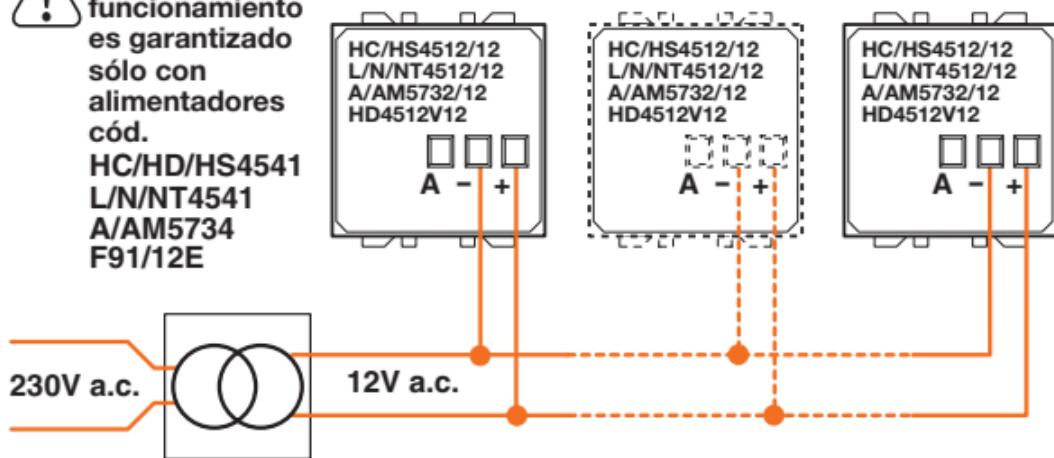
Para sistemas con 3 aparatos, utilice el transformador
