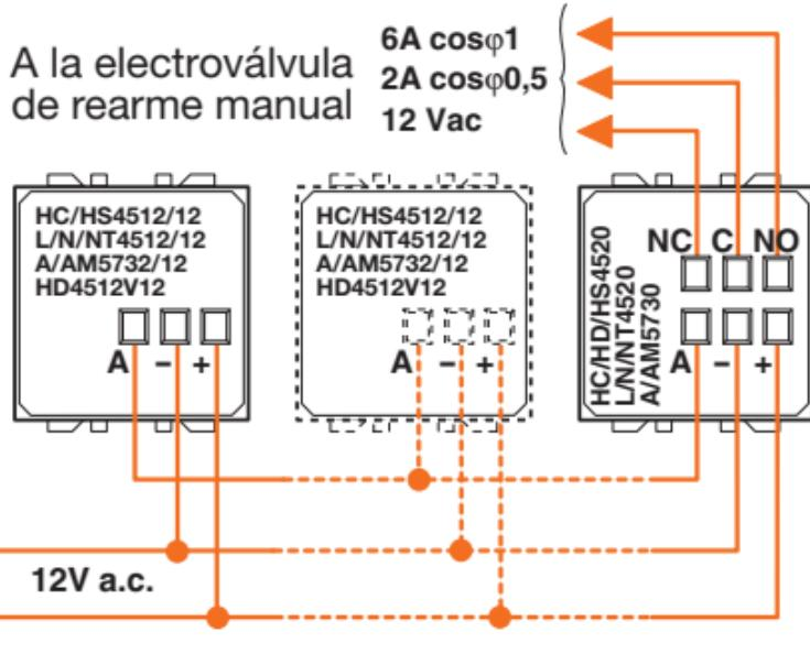
Para sistemas con 3 aparatos, utilice el transformador
