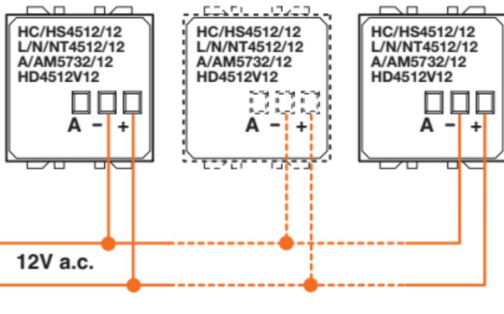
Per impianti con 3 apparecchi utilizzare il trasformatore art. F91/12E, ed elettrovalvole a 12V.
