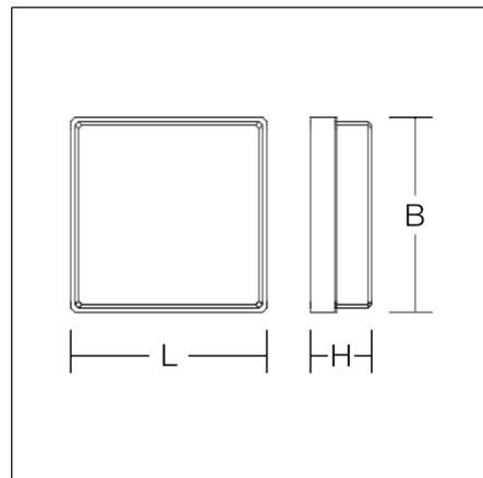
Quadratische Hausnummernleuchte. Armatur Kunststoff. Diffusor Kunststoff opal seidenmatt. Befestigung des Diffusors mit Federsystem. Mit Dämmerungsschalter, über DIP-Schalter in mehreren Stufen einstellbar (2-500 lx). Beschriftung bitte separat bestellen!
