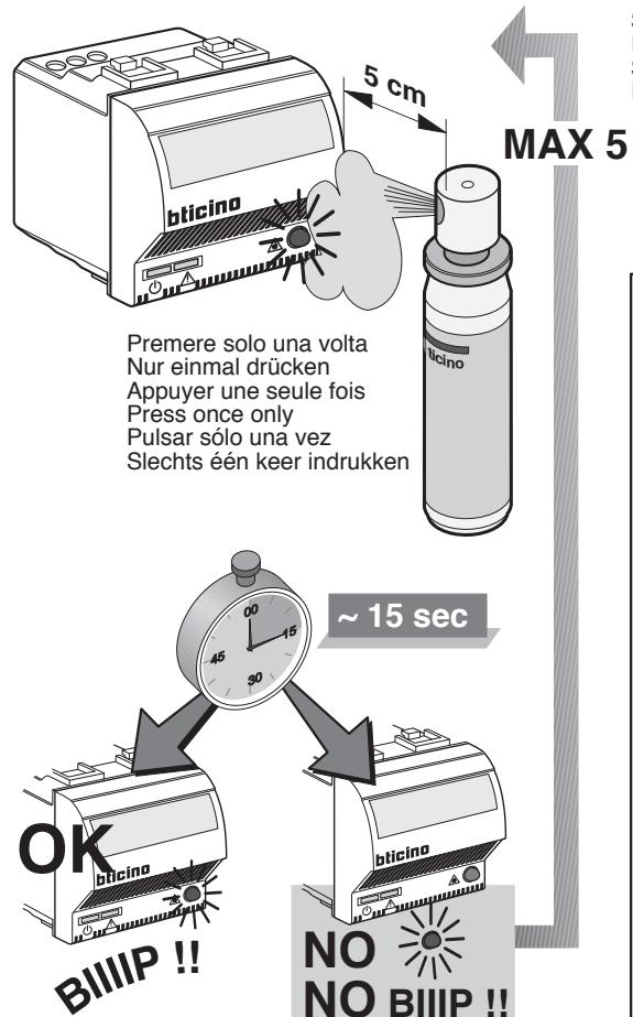
Se il rilevatore non va in allarme
