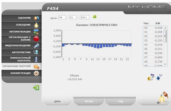
На этой странице можно также сравнить два измерительных прибора для отображения баланса между потреблением и производством энергии системы.
