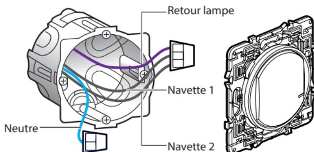
Utilisez un **connecteur** pour raccorder ensemble les 3 fils (retour de lampes, navettes 1 et 2). Utiliser un connecteur séparé pour isoler le fil de neutre.
