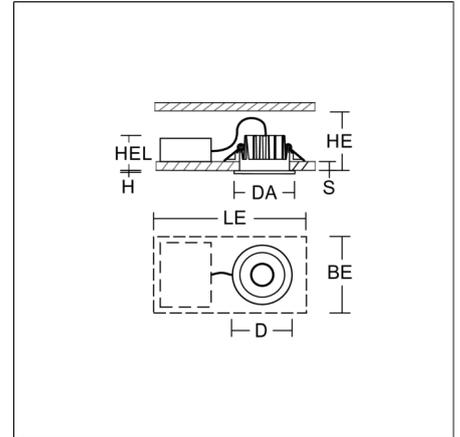
Runde Sicherheitsleuchte zur Rettungswegbeleuchtung. Gehäuse Aluminium-Druckguss. Abdeckung Kunststoff. Mit Kunststofflinsen zur Flächenbeleuchtung. Einzelbatteriesystem mit automatischem Selbsttest und Rückmeldung über DALI-Bus ausschließlich an das RZB DALI-Überwachungssystem. Mit beiliegendem separaten Deckeneinbauring auch für Deckenausschnitte von Ø 68 mm geeignet.
