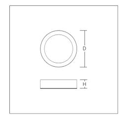
Downlight apparent ultra-plat. Pour éclairage de voies de secours. Boîtier cylindrique en tôle d'acier traité époxy. Anneau en aluminium injecté, traité époxy. Guide de la lumière et diffuseur en plastique PMMA ne jaunissant pas, opalin mat. Système de batterie autonome avec auto-test automatique et retour d'information par bus DALI exclusivement au système de RZB surveillance DALI.
