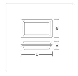
Luminaire pour éclairage des issues de secours. Armature en matière synthétique (polycarbonate). Corps et diffuseur opalin en matière synthétique résistante aux chocs (polycarbonate). Appareillage intégré. Convient pour le raccordement à l'alimentation centrale en électricité de secours. Avec module de contrôle AC-Control pour les installations à batterie centrale LUXIFAIR.
