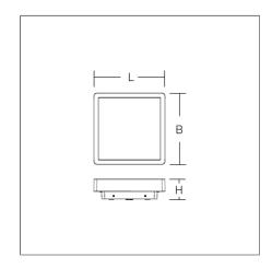
Wandleuchte. Gehäuse Aluminium-Druckguss pulverbeschichtet. Diffusor Kunststoff (Polycarbonat) opal. Betriebsgerät integriert.
