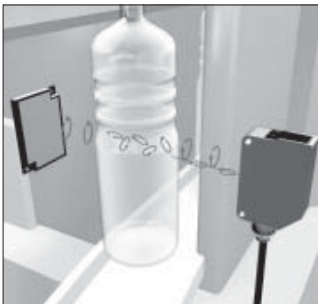
Utilisation de l'effet de double réflexion sur les objets en PET pour assurer une stabilité de détection supérieure (sur les modèles
