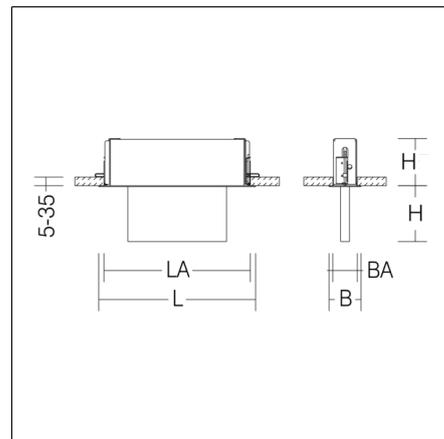
Luminaire pour la signalisation des voies d'évacuation. Boîtier encastrable en tôle d'acier. Plaque de plafond acier inox brillant ou traité époxy. Plaque display en matière synthétique haute transparence avec pictogramme de secours simple/double face. Appareillage intégré. Système de batterie autonome avec auto-test automatique. Merci d'indiquer le numéro de motif du pictogramme de secours lors de la commande
