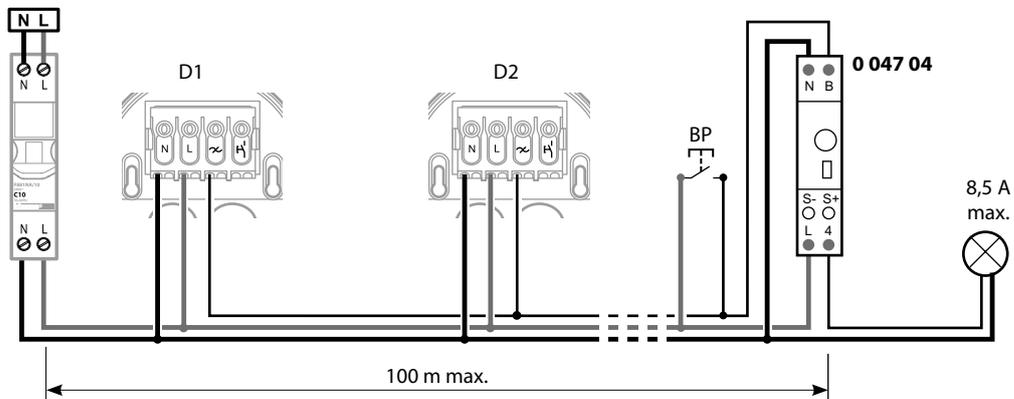
Collegando il sensore in questa maniera, il «tempo di ritardo» sarà regolato tramite timer esterno. Il parametro della «Funzione impulso» dovrà avere valore 0 (vedere paragrafo 7. Funzionamento).
