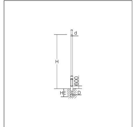
Mât lumineux cylindrique en acier. Galvanisé à chaud selon DIN EN ISO 1461. Épaisseur de mur 3 mm. Trappe du mât affleurante, 85 x 400 mm, selon DIN 48778 avec verrouillage à 3 arêtes, autres fermetures sur demande. Arête de l'appareil avec deux écrous coulissants et une patte de mise à la terre. Orifice de câble 50 x 150 mm (bord inférieur de l'orifice de câble 500 mm sous terre)
