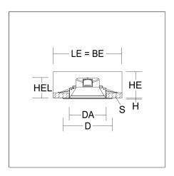
Rundes Einbau-Downlight. Gehäuse Aluminium, kunststoffbeschichtet. Passive Kühlung. Diffusor aus Kunststoff (Polycarbonat) opal, schlagzäh. MultiColour: Farbtemperatur mit Schaltelement einstellbar. Auswahlmöglichkeit 3000 K, 4000 K oder 5700 K. Werkseitig auf 4000 K eingestellt. Werkzeugloser Einbau durch Federbefestigung. Betriebsgeräte eingebaut.
